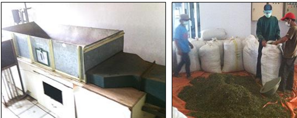
Gambar 7. Pengeringan daun stevia dengan aliran udara panas 50-70 °C (kiri), pengemasan daun kering stevia (kanan).
